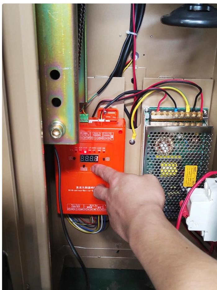
若“F-39”自动学习没有用，将“F-37”重新设置电机正反转。
